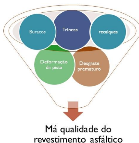
Figura 6: Alguns tipos de patologias de revestimento asfáltico Fonte: Elaboração própria da autora
