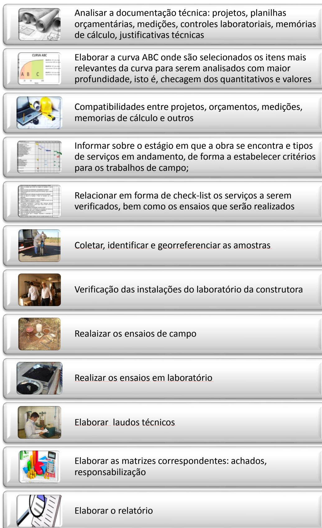
Figura 5 – Síntese do roteiro adotado pela equipe de engenharia do TCE para a atuação nos trabalhos de auditoria em obras rodoviárias. Fonte: Elaboração própria da autora
