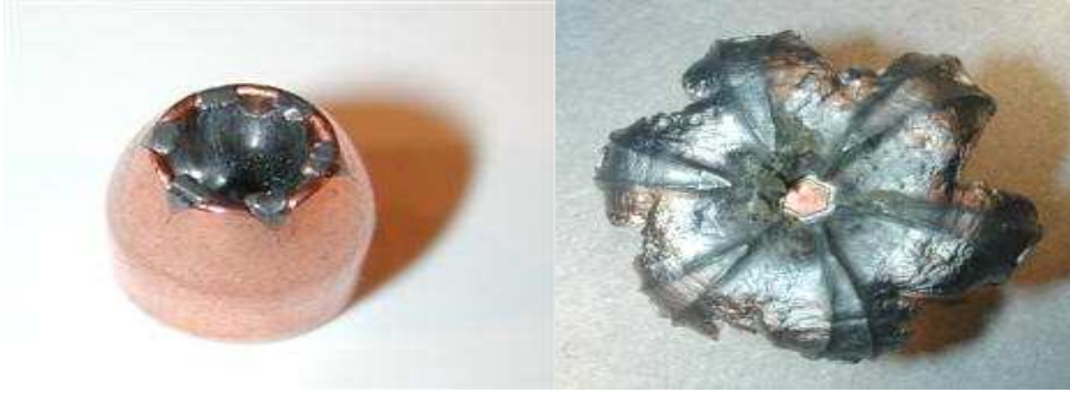
Fig. 14 – Projétil encamisado ponta oca marca Speer (USA) - antes e após o disparo, demonstrando a expansão após impacto (fonte: speer bullets)
