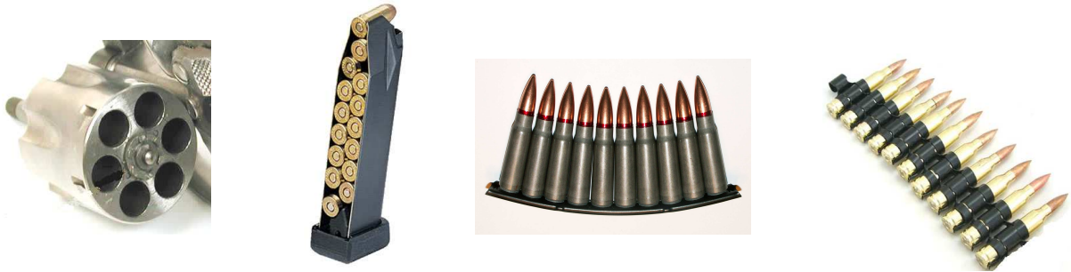
fig. 02 Tambor de revólver, carregador de pistola em corte, clipe destacável e fita metálica. (fonte: Identificação de Munições vol I)
