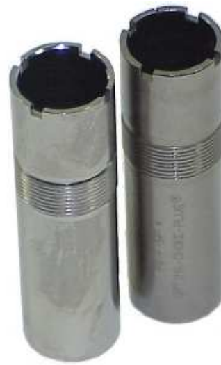
Fig. 38 - Choque. Acessório que é rosqueado no interior da saída do cano para controlar a dispersão do tiro. (Fonte: Armas Ligeiras de Fogo)
