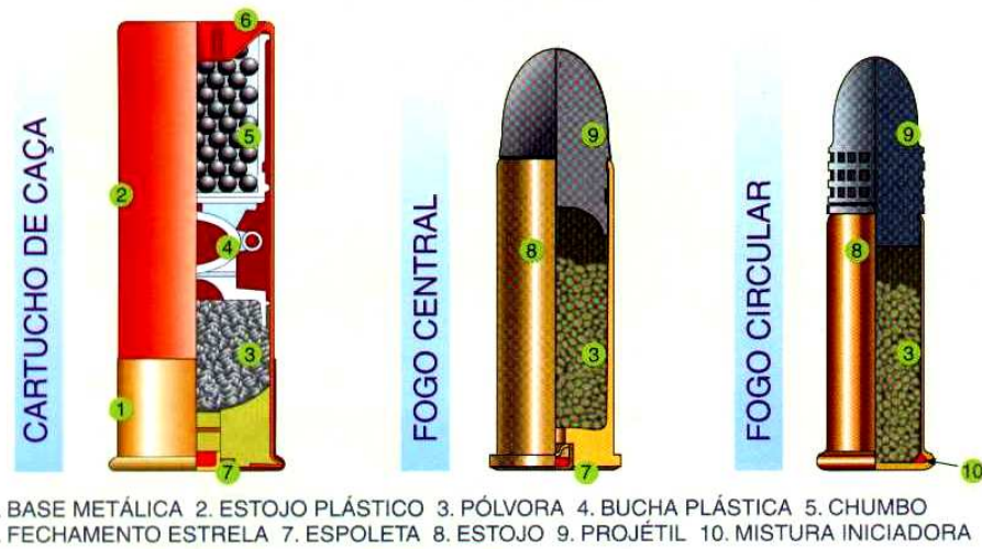
Fig. 21 - desenho esquemático comparativo das munições de uso mais comum: cartucho de caça (ex. calibre 12, 16, 20 etc.), cartucho fogo central (calibres 38 SPL, 380 ACP, 7,65, etc.) e cartucho fogo circular (calibre .22 LR e mais recentemente o novo calibre .17HM2). Fonte: CBC
