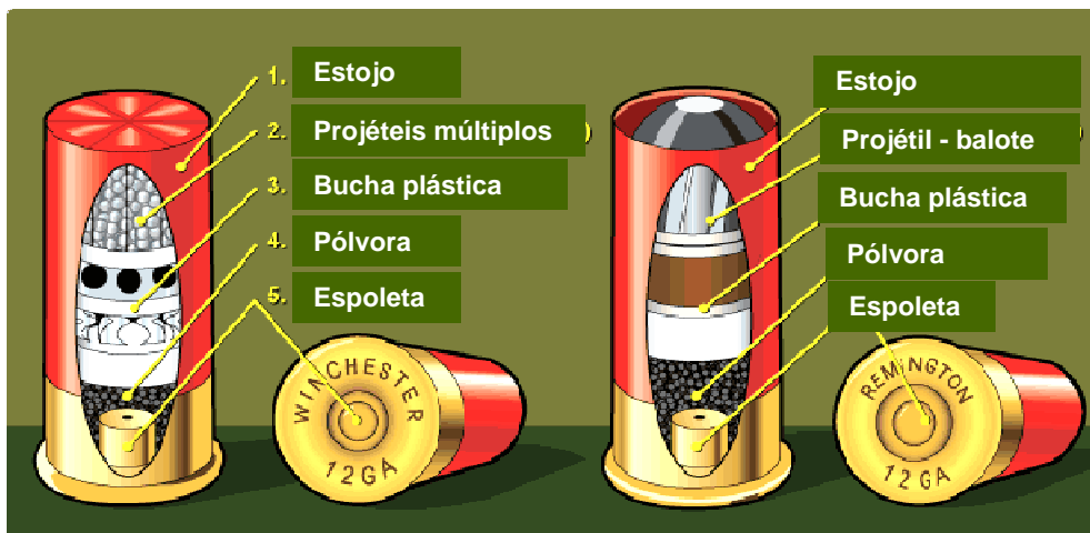
Fig. 20 – corte esquemático de um cartucho de caça (Fonte: Hunter Exam c/ adaptações do autor)
